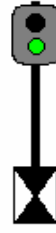
Fig. 38. LIBER cu viteza stabilită! Semnalul următor este pe liber cu viteza stabilită Ziua și noaptea - o unitate luminoasă de culoare verde, spre tren
