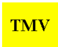
Fig. 108. Reperul pentru indicarea intrării pe o secție de circulație cu semnale luminoase cu trepte multiple de viteză
