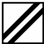
Fig. 146. Atenție, halta comercială sau punctul de oprire în linie curentă este la 1000 m!
