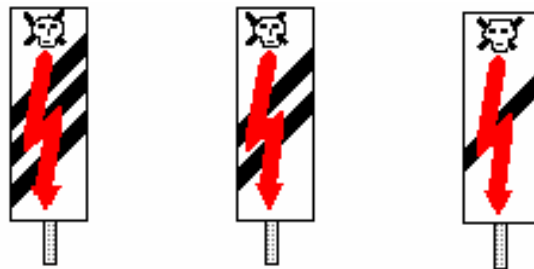
Fig.209 Balize avertizoare pentru indicarea intrării pe secții de circulație cu linie electrificată
