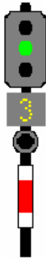
Fig. 76. Liber cu viteza stabilită. Semnalul următor indică liber cu viteza redusă prevestită de către indicatorul luminos prevestitor de viteză – prin cifrele 2, 3, 6, 8, 10. În figură, cifra 3 înseamnă 30 km/h
