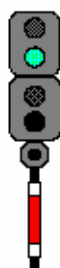
Fig. 27. LIBER cu viteza stabilită. Semnalul următor este pe liber cu viteza stabilită
