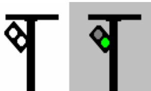
Fig. 10. LIBER cu viteza stabilită. Semaforul următor este pe liber pe linia directă Ziua - paleta văzută pe muchie Noaptea - o unitate luminoasă de culoare verde, spre tren
