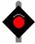
Fig. 51. Pericol la trecerea la nivel! Ia toate măsurile pentru oprire! Ziua și noaptea - o unitate luminoasă de culoare roșie, spre tren
