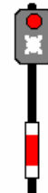
Fig. 231 LIBER cu viteza de cel mult 20 km/h cu deosebită atenție până la semnalul următor.
